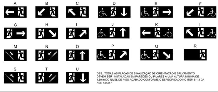
OBS.: TODAS AS PLACAS DE SINALIZAÇÃO DE ORIENTAÇÃO E SALVAMENTO DEVEM SER INSTALADAS EM PAREDES OU PILARES A UMA ALTEZA MÍNIMA DE 1,80 m DO NÍVEL DE PISO ACABADO CONFORME O ESPECIFICADO NO ITEM 5.1.3 DA NBR 13434-1
