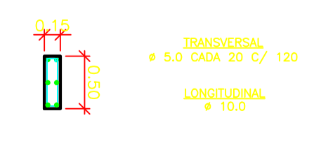
VIGA DE TRAVAMENTO TRANSVERSAL 1/50
